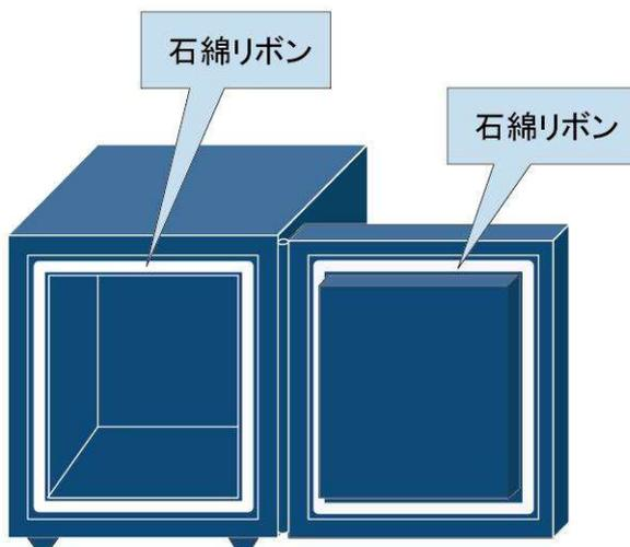
※石綿リボンは金庫の機種により扉の裏側及び本体額部の周囲のいずれかに使用されている製品があります。
